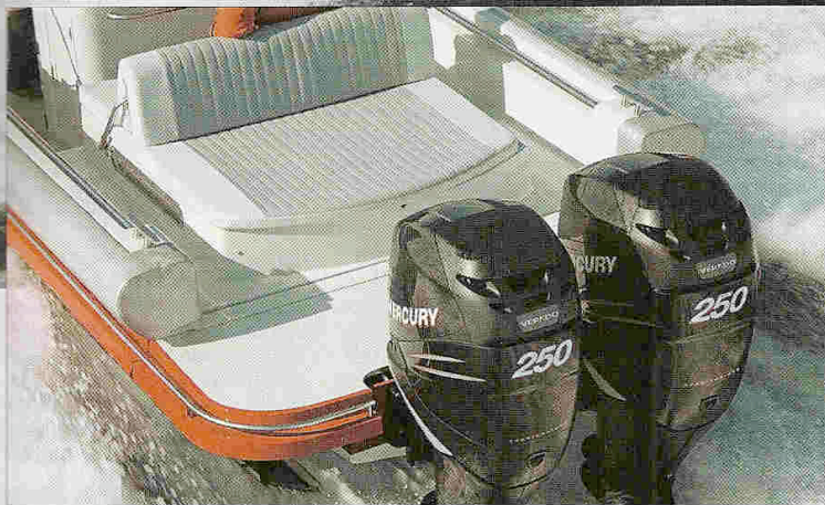
Les deux Verado totalisent un poids de 576 kg en porte-à-faux sur la plage arrière...
