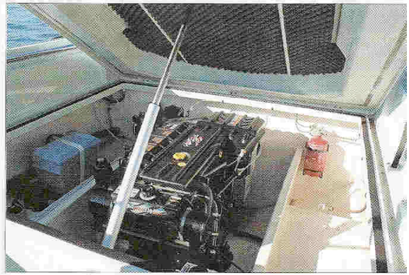
L'accessibilité de l'in board facilitera certainement les interventions mécaniques d'urgence en mer par rapport au hors-board.
