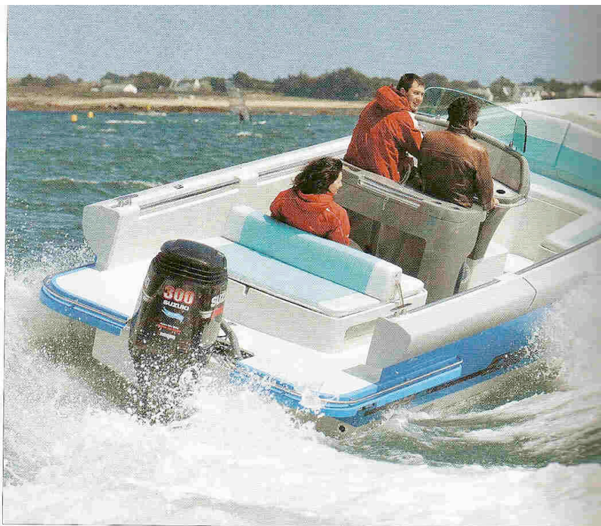
Grâce à sa carène très en V, l'Expression 25 HBS observe un angle de gîte très marqué en courbe.
