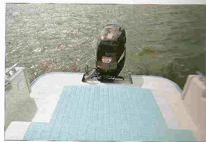
La plage de bain fait office de bracket pour le moteur hors-bord.
